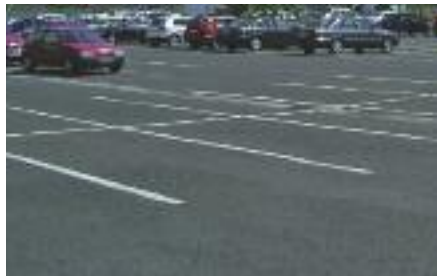
Auf versiegelten Flächen, wie diesem Parkplatz, kann das Regenwasser nicht versickern. Die Folge sind Hochwasser in den Bächen, die die Tiere und Pflanzen im Gewässer stark belasten. [kfm / pixelio.de]
