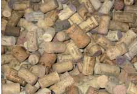
Ausschließlich Naturkorken sind für das Dämmgranulat „ÖKOrk“ verwertbar. [G. Teenck]
