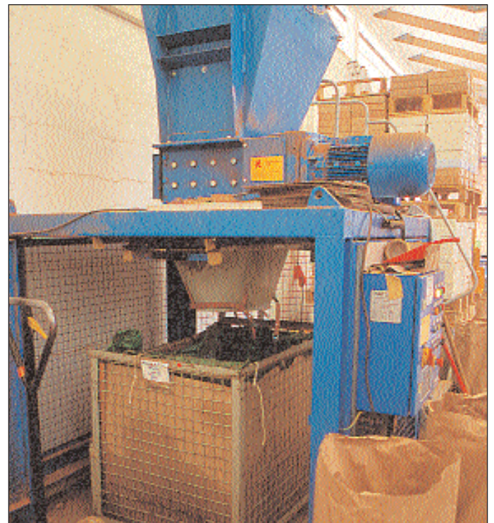
Hier werden die Flaschenkorken geschreddert und anschließend zu Dämmmaterial verarbeitet
